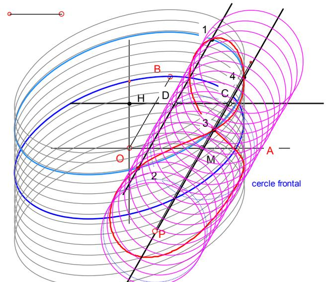
Les intersections de ces deux génératrices avec l'ellipse translattée donnent deux points ("1" et "2" ou "3" et "4") dont on demande les lieux (on a intérêt à limiter le déplacement de H sur le segment utile de centre O sur l'axe vertical). En déplaçant les différents éléments (les points M et la taille du curseur) de construction de la figure on obtiendra toutes les formes possibles d'intersection de deux cylindres d'axes perpendiculaires.
